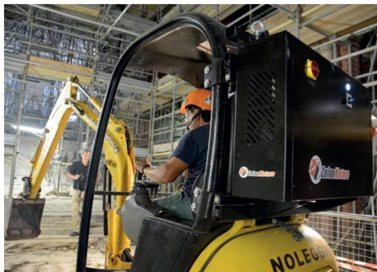
cavo di collegamento alla fonte di elettricità (380 o 220 V) si può ricavare sia sul lato sinistro che destro della cabina. Il supporto al cavo (estraibile) si estende per circa 1,5 metri dall'ingombro della macchina. Senza creare alcun impedimento al raggio di lavoro.
